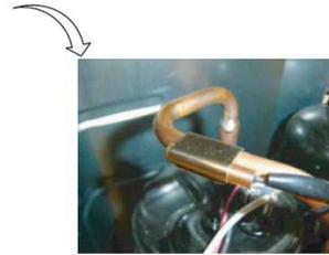
Remove the Thermistor(Discharge).
