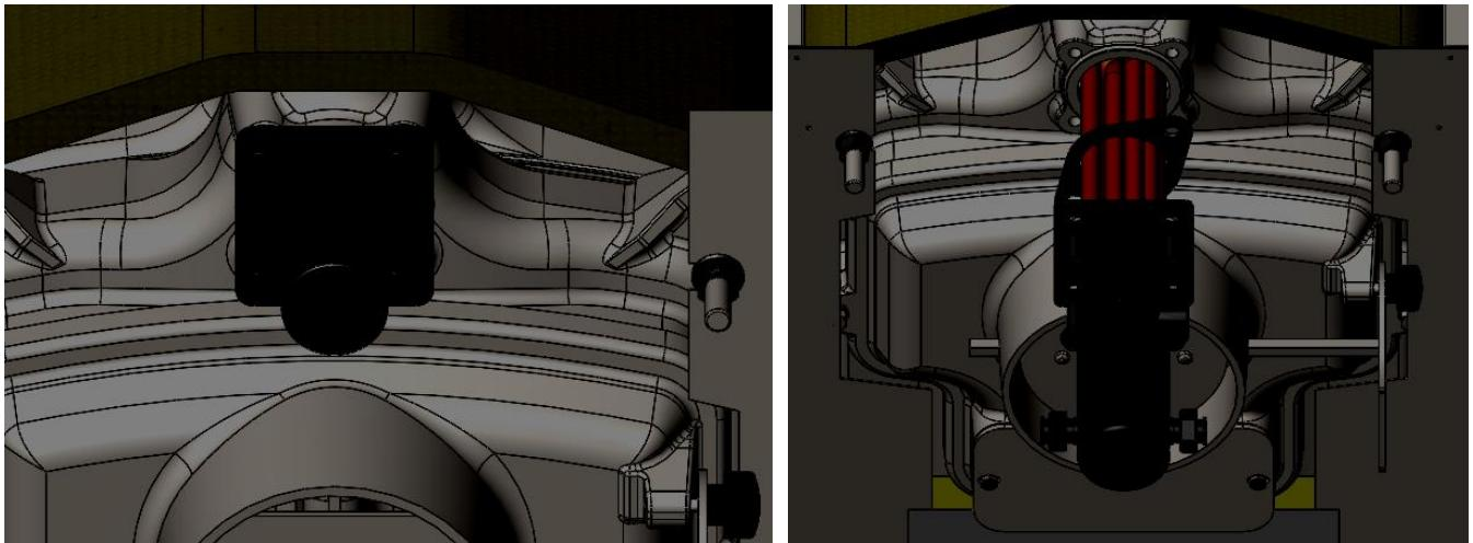
2. Подключите предохранительный клапан Regulus JBV в корпусе 1/2 дюйма к линии подачи горячей воды теплообменника, как показано справа. Обратите внимание на поток холодной санитарной воды через предохранительный клапан. Это указано на латунный корпус предохранительного клапана.
