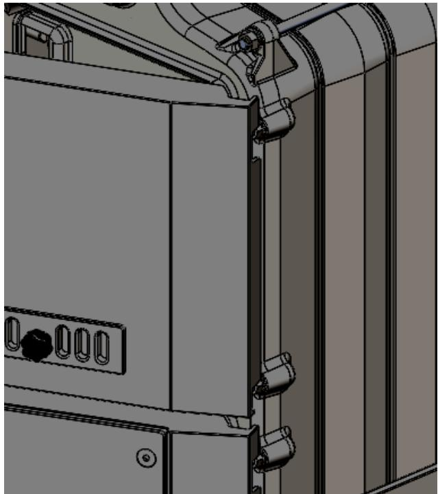
3. Установите рычаг цепи регулятора на заслонку первичного воздуха на нижней передней дверце:
