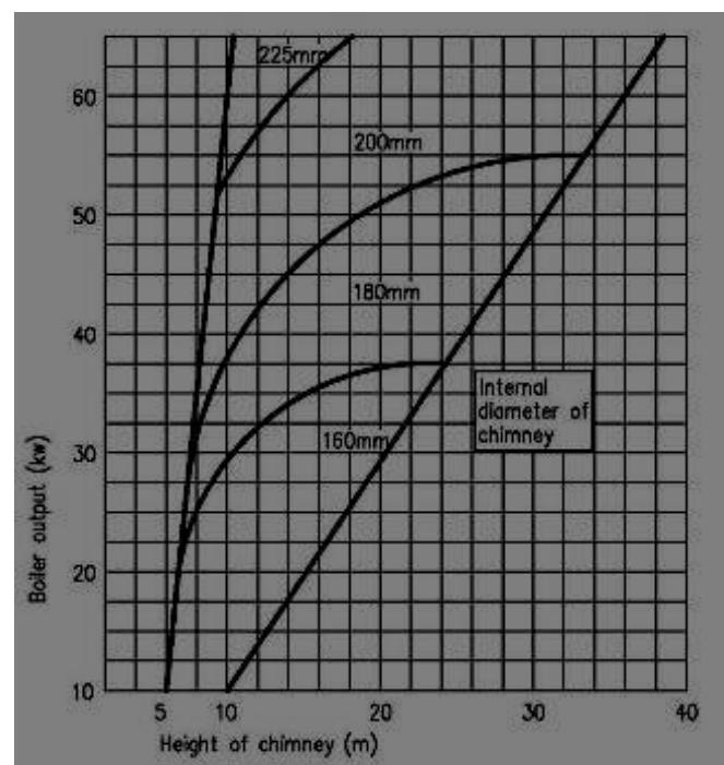
Самый высокий уровень дымохода снаружи должен соответствовать размерам, приведенным на следующем рисунке, чтобы уменьшить вредное воздействие дымовых газов на окружающую среду и улучшить тягу в дымоходе.
