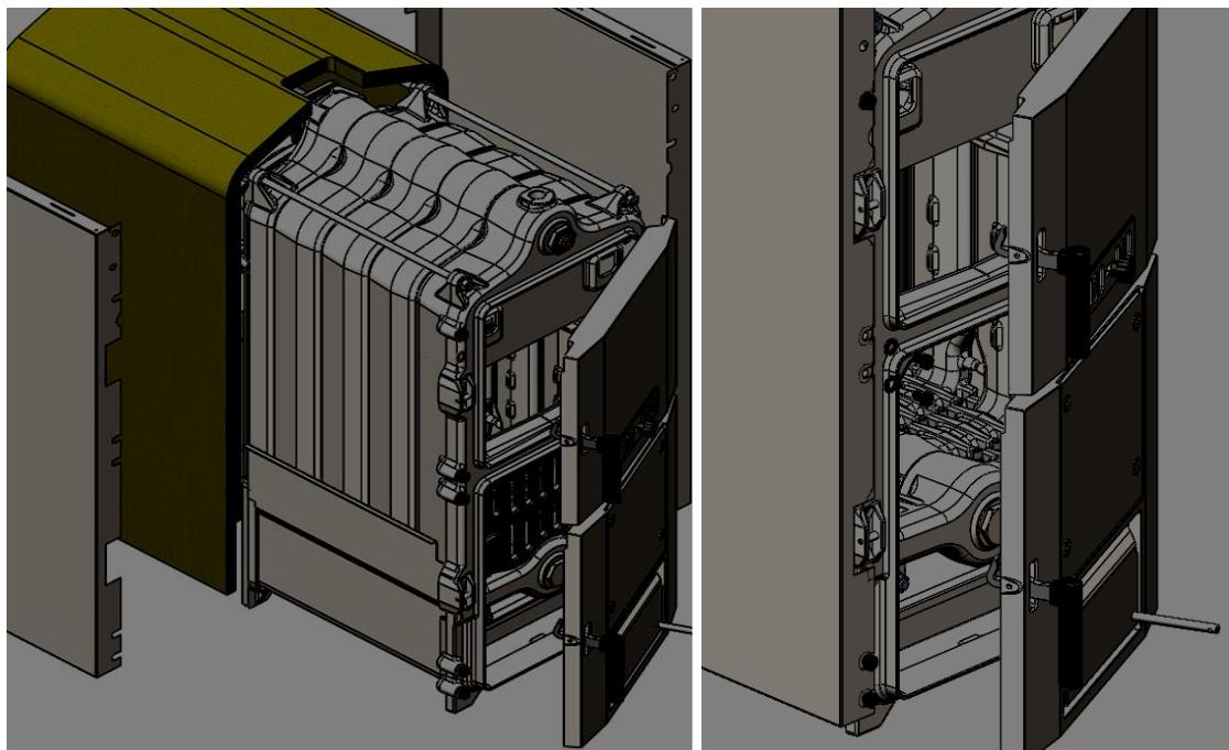
5. Установите заднюю изоляционную панель, затем закрепите заднюю панель четырьмя саморезами 4,2x9,5, как показано ниже.
