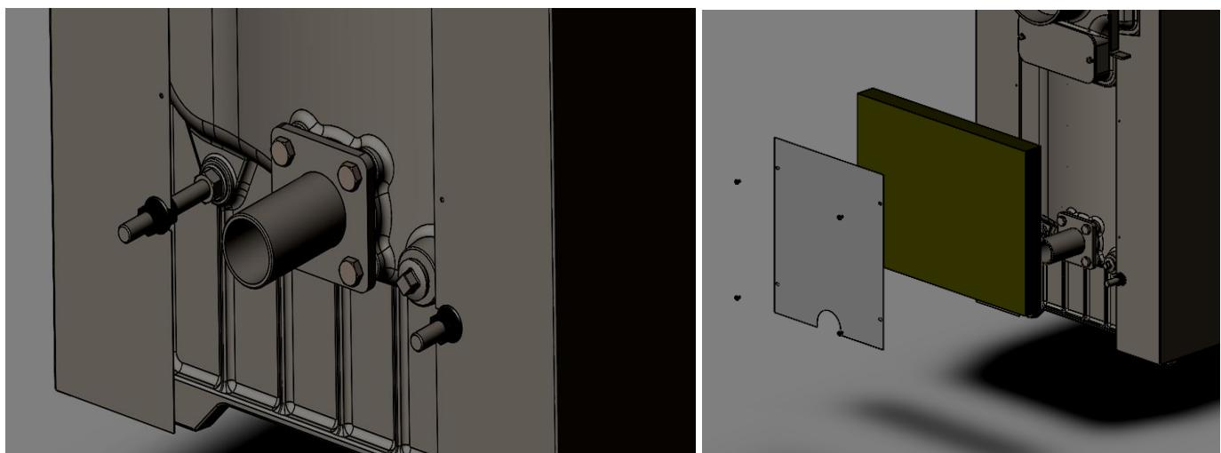
6. Установите переднюю панель на боковые панели, закрепив ее четырьмя винтами M8. Вставьте термометр, входящий в комплект принадлежностей, в круглое отверстие на верхней панели, прикрепите его датчик к переднему карману, как показано ниже. Затем закрепите верхнюю панель четырьмя саморезами 4,2x9,5.
