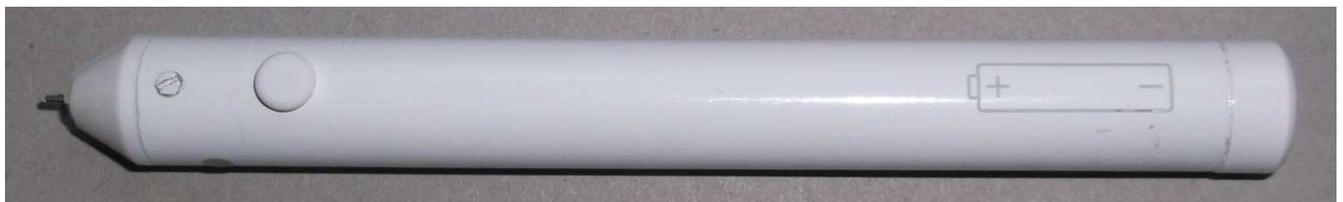
Das Gehäuse wurde von außen mit Pulverfarbe lackiert.
